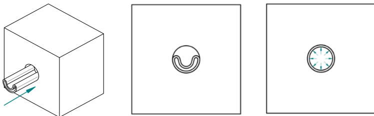
Рис. 6 Установка теплоизоляции в канал трубы
